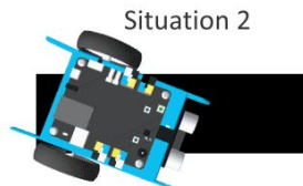
Situation 2 Capteur de droite "voit" du blanc, capteur de gauche "voit" du noir
