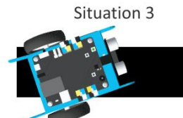
Situation 3 Capteur de droite "voit" du noir, capteur gauche "voit" du blanc
